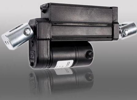
Este modelo de horquillas tuerca es utilizado para cuando el actuador va a describir con su movimiento lineal un movimiento circular. Con este sistema el actuador posee doble articulación en el plano de giro. La regulación del actuador se hace con los tornillos que rosan en ambos extremos de las tuercas.
