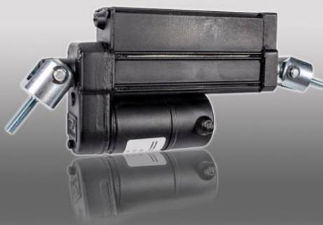
Este diseño de horquillas tornillo en ambos extremos es utilizado para cuando el actuador va a describir con su movimiento lineal un movimiento circular en el plano de giro. Además le permite algún grado de libertad mayor en el otro plano con un pequeño juego que posee entre la horquilla y el pistón o soporte del actuador.
